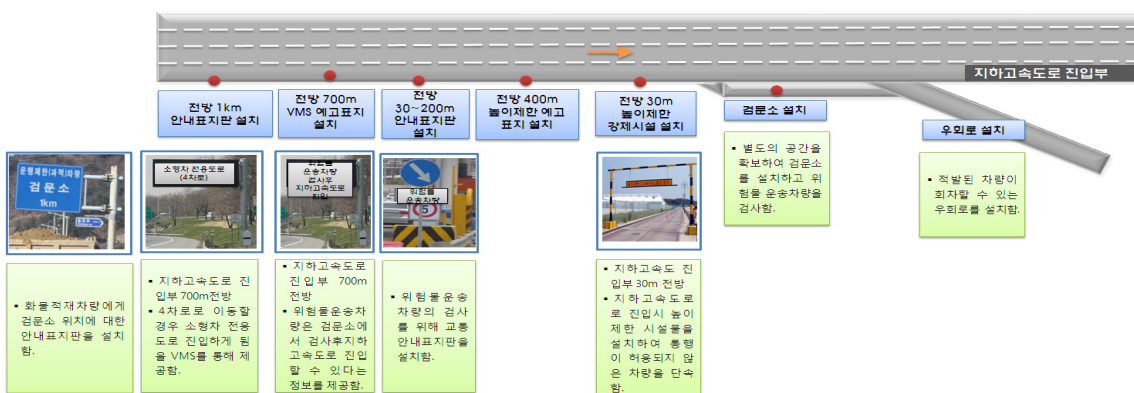
〈그림 1〉 지하고속도로 진입 전 사전 단속(허용차종, 속도, 과적 및 위험물 단속)
