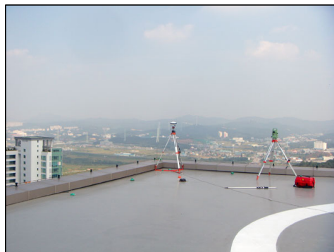
그림 5. TS에 의한 GPS기선거리 확인측량
