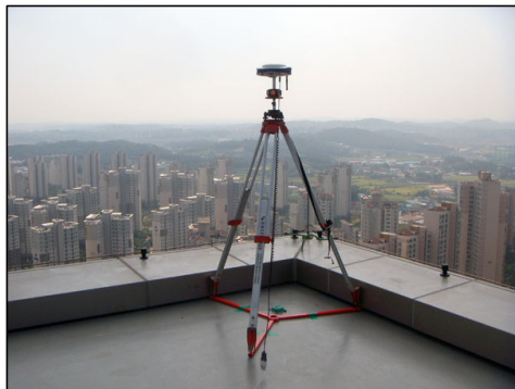
그림 4. 헬리포트에 설치된 이동국 GPS 및 전방향 반사경
