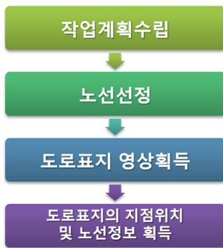
그림 5. MMS를 이용한 도로표지 조사 공정
