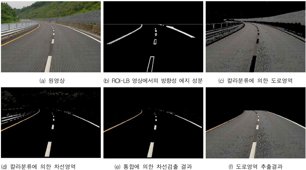
그림 9. 평균휘도 115의 흐린 날씨 및 미끄럼방지 도로에서의 실험결과
