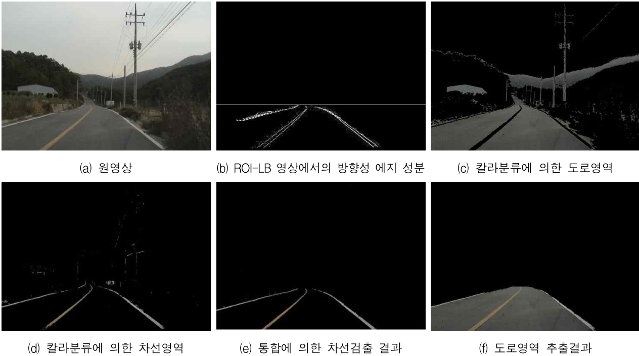
그림 11. 평균휘도 120의 저녁무렵 시골길에서의 실험결과 Fig. 11. The experimental result for the 120 average luminance on the sunset time.
