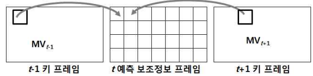
그림 7. 수신된 움직임 벡터를 이용한 예측 보조정보 프레임 복원 Fig. 7. Compensation of predicted side information based on received motion vectors.
