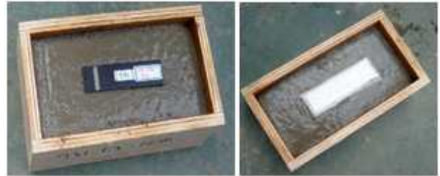
그림 1. 콘크리트 블럭에 매립 중인 RFID 태그 Fig. 1. Placement of RFID tag in a wooden concrete frame.
