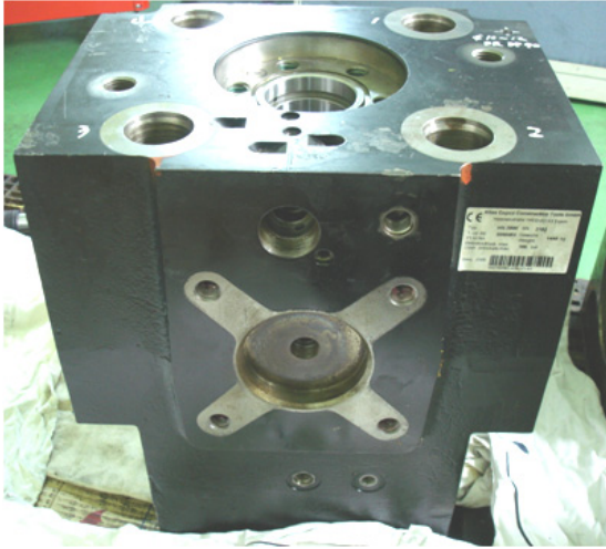
그림 4 Atlas Copco 유압브레이커 주조 기술 접목 부품류
