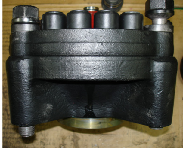
그림 4 Atlas Copco 유압브레이커 주조 기술 접목 부품류
