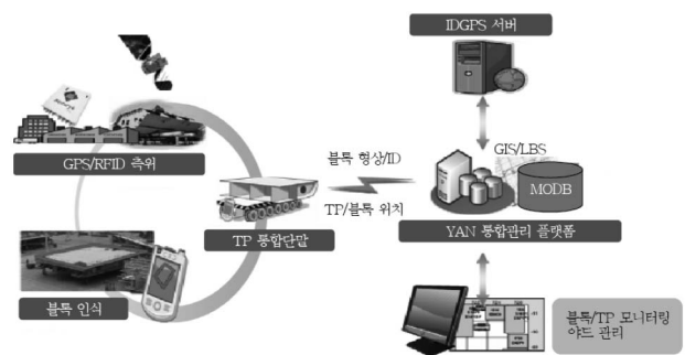
그림 2. 조선소 블록 실시간모니터링 개념도(박정호 외, 2010)
