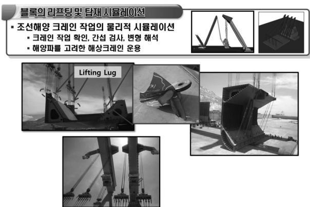
그림 3. 블록의 크레인 리프팅 및 탑재 시뮬레이션
