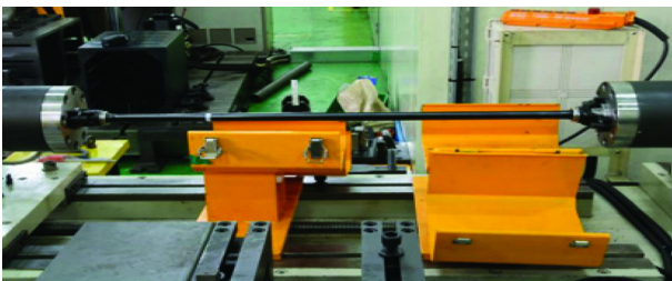
Fig. 9 Torsion bar test rig ( \pm 4\text{KNm} \times 2500\text{mm} )
