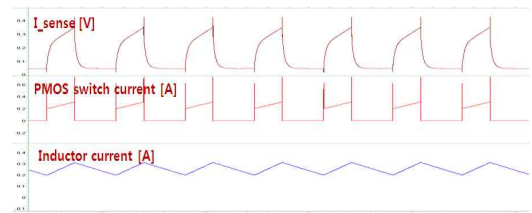
Fig. 14. Current-sensing circuit simulation results 그림 14. 전류 감지회로 시뮬레이션 결과
