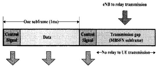
그림 2. Type I Relay 동작 방식
