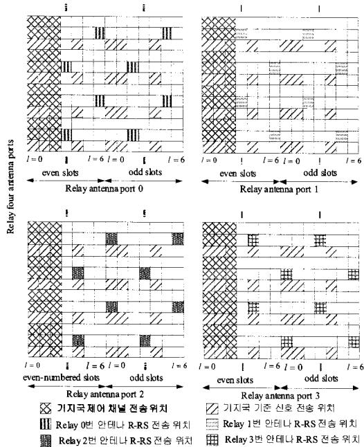
그림 14. Relay-RS 구조
