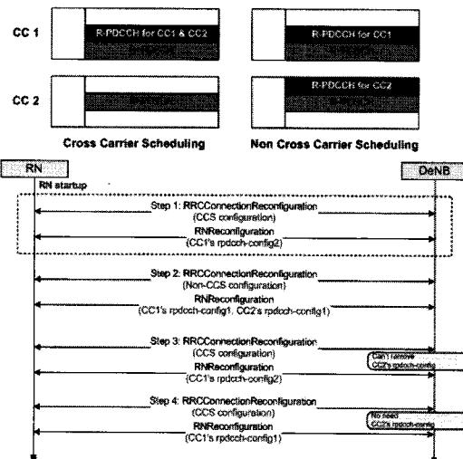
그림 8. Normal allocation에 의한 R-PDCCH 할당
