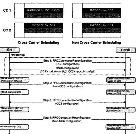
그림 9. Pre-allocation에 의한 R-PDCCH 할당
