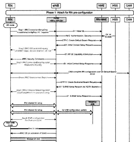
그림 12. Un 팀크 CA 적용을 위한 Relay Startup 절차
