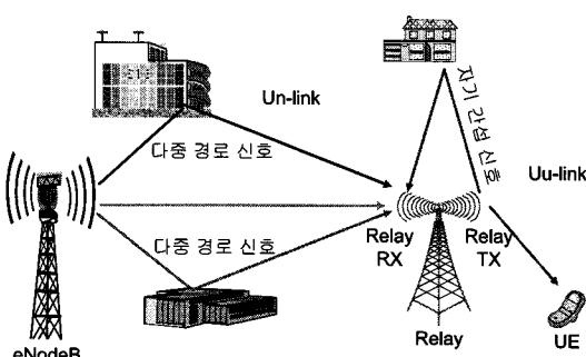
그림 13. 자기 신호 간섭에 의한 Relay 성능 저하
