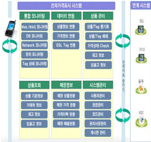
그림 4. 전자가격표시 시스템 기능 구성도
