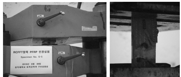
Fig. 6 PFRP 인장강도실험 시편 및 실험 형태
