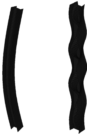
(a) 전체좌굴 (b) 국부좌굴 Fig. 1 FRP I형 단면 부재의 좌굴모드
