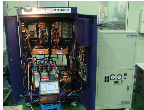
그림 18 SDF 인버터 유도가열 장치 Fig. 18 SDF Inverter for Induction Heating
