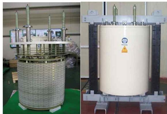
그림 1. 고온초전도 팬케이크 권선(좌) 및 1 MVA 초전도변압기(우).
