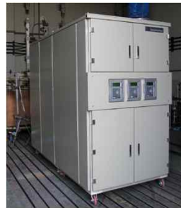
그림 2. 22.9 kV, 3,150 A 3상 하이브리드 초전도 한류기 단락시험 모습과 결과.
