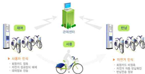
<그림 22> 기존 무인 자전거 대여 시스템[7]
