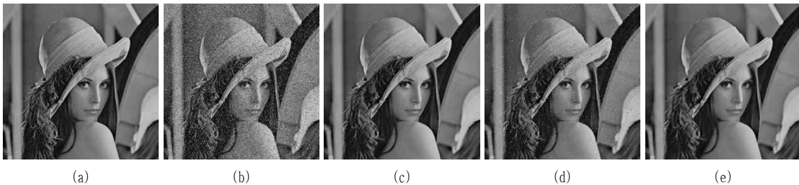
<그림 6> Lena, (a) 원영상, (b) 임펄스 잡음영상(35.91dB), (c) 미디언 필터 잡음제거 영상, (d) 래서널 필터 잡음제거 영상, (e) 제안하는 잡음제거 영상
