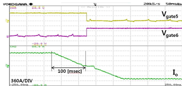
그림 20 저주파 인버터의 ZCS 극성반전 Fig. 20 Waveforms of each parts
