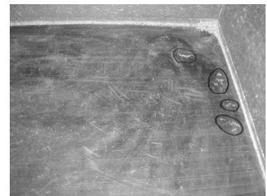
(c) 시험 후 시편(자갈10mm)
