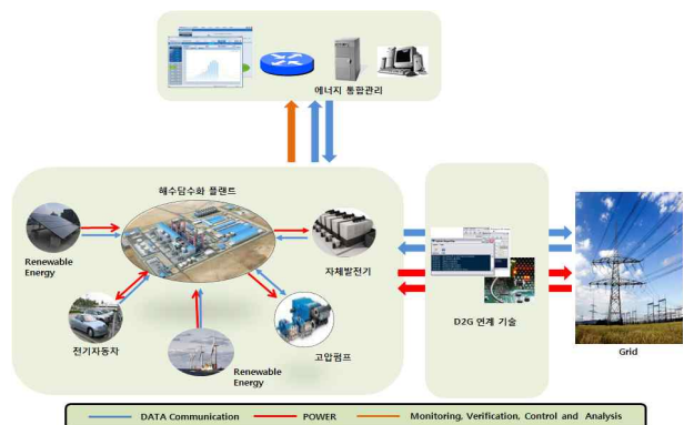
그림 2. 전력망 연동형 해수담수화 플랜트 개념도 Fig. 2. Gridable sea water reverse osmosis plant
