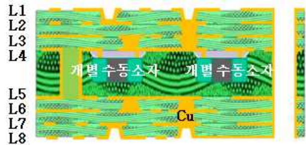
그림 2. 8층 SiB(System-in-Board) 구조의 임베디드 인쇄회로기판의 단면 구조도
