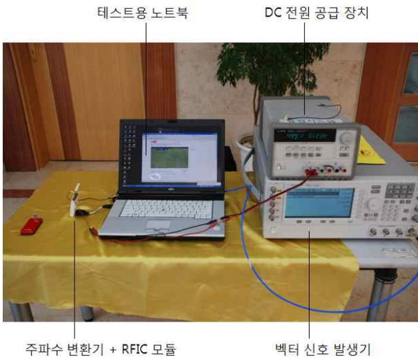
그림 6. WiBro 신호를 이용한 쿼드 밴드 모듈 인터넷 접속 테스트
