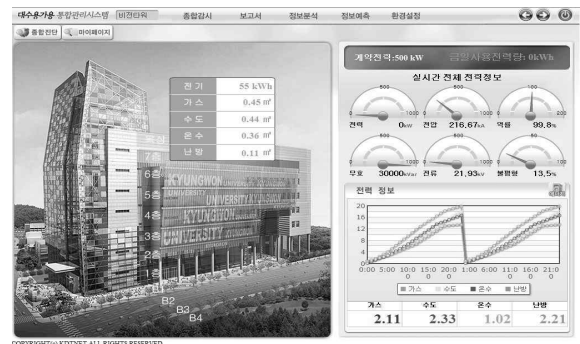
그림 1. 전력감시 사용자화면 Fig. 1. Power Monitoring HMI
