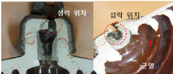
그림 2 자기 현수애자의 고장사례 Fig. 2 Failure case of the insulators
