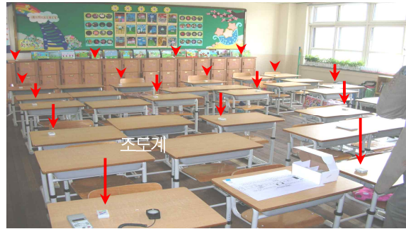
그림 17. 교실에 설치된 조도센서의 위치 및 현황모습
