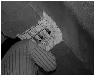
(a) 변형 측정용 Strain Gauge 부착
