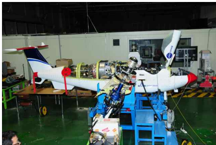
그림 7. 나셀 틸트 작동기 시험
