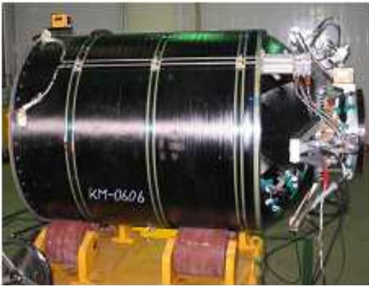
그림 7. 키크모터 시스템 지상 연소시험을 위한 추력 축 정렬
