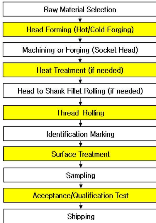
그림2. 소켓헤드 캡 스크류 제조 공정
