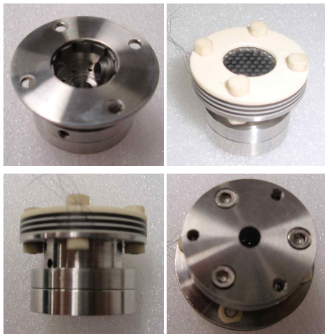
그림 5. 이온추력기 기본 모델 조립 형상
