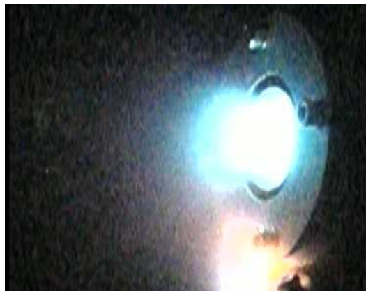
그림 12 ECR 방전 시험 결과 (with acceleration voltage)
