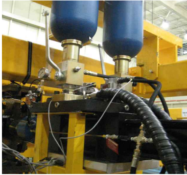
그림 3. 원심력을 부가하기 위한 유압작동기 및 축압기 설치 형상
