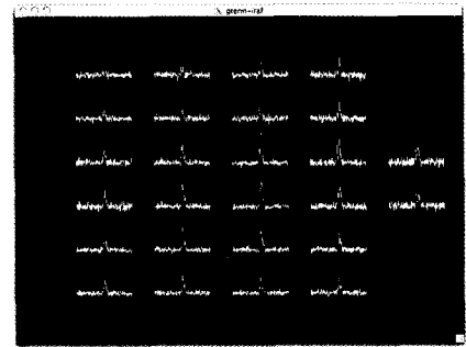
▶ 그림 1 : W51 천체에 대해 다중빔 수신기를 이용하여 두 번 관측으로 26개의 스펙트럼을 얻은 모습. 5번 픽셀과 15번 픽셀은 이상이 있어서 관측에서 제외하였음.
