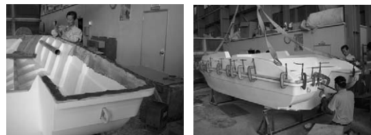
Fig. 16 선체와 데크 결합
