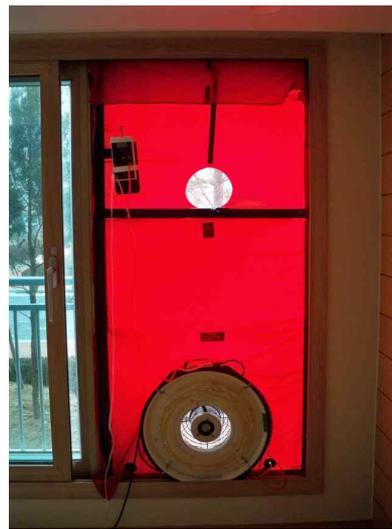
그림 3. Blower Door Test
