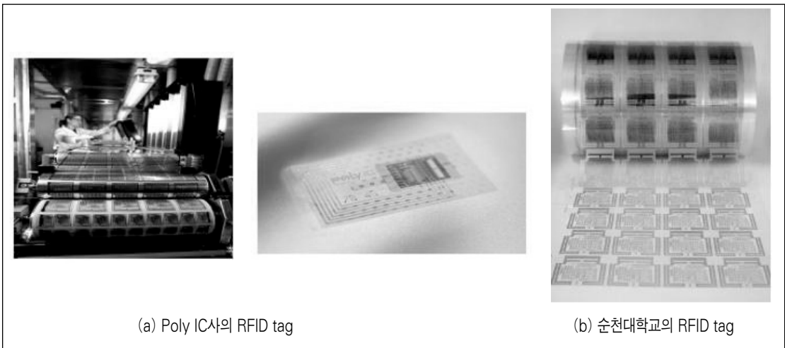
[그림 10] 롤투롤 공정에 의해 제작된 RFID Tag
