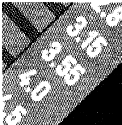
그림 7. -25^\circ 로 회전된 그리드를 사용한 x선 투사영상의 일부(투사영상 크기: 2560 \times 3072 , 14b/pixel, image detector: DRTECH FDXD1417, grid: JPI 103lines/inch) Fig. 7. Part of the x-ray projected image obtained by using -25^\circ -degree rotated grid (image size: 2560 \times 3072 , 14b/pixel, image detector: DRTECH FDXD1417, grid: JPI 103lines/inch).
