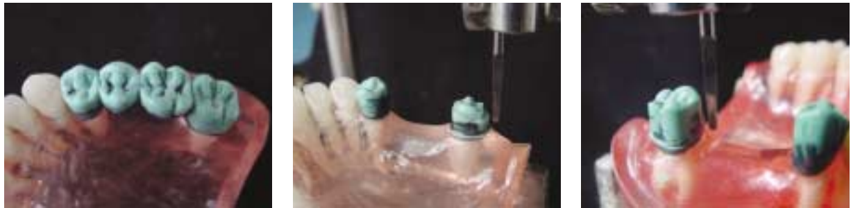
그림 3. 4unit bridge 제작을 위한 지대치 wax milling
