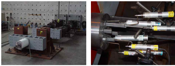
사진 3. 강연선, 썬기, 앵커블록의 정적/피로시험
