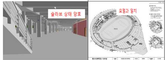
그림 3. BIM 모델과 도면의 일치성 확인(1)
