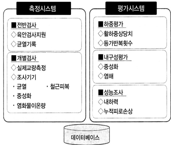
그림 4. 건전도 평가시스템(콘크리트 구조)
