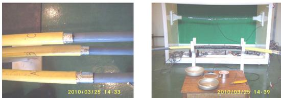
(a) 가공된 케이블 시료 말단 (b) 케이블 시료 설치
