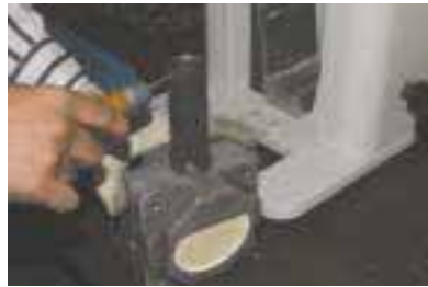
그림 19. cartridge sleeve를 플라스크에 체결
