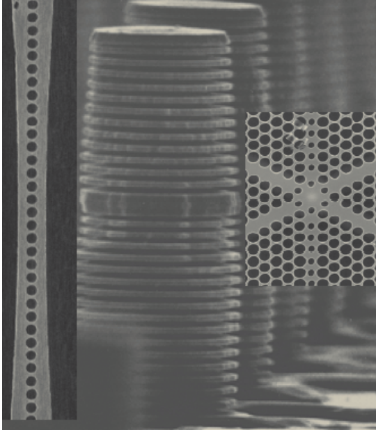
그림 9. VCSEL, 광결정 레이저, 나노사다리 레이저. 그림의 크기는 각 구조의 설계 파장으로 규격화(normalize)하였음. 광결정 레이저와 나노사다리 레이저의 두께는 빛의 반파장 정도이다.
