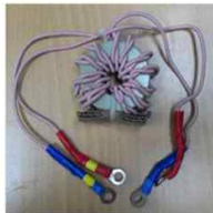
그림 6 제작된 결합 인덕터와 제정수 값 Fig. 6 Coupled inductor and parameters
