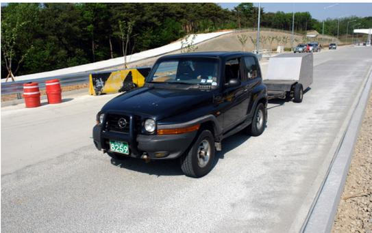
그림 17. CPX Trailer를 이용한 근접소음 측정
