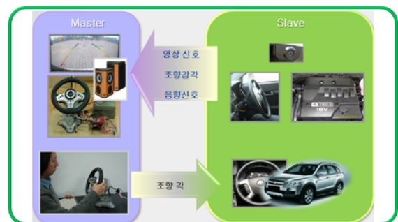
그림 1. 원격지 현장감 전달을 위한 무인차량 원격조종 시스템. Fig. 1. Teleoperation system of Unmanned grounded vehicle for transmitting transparency.
