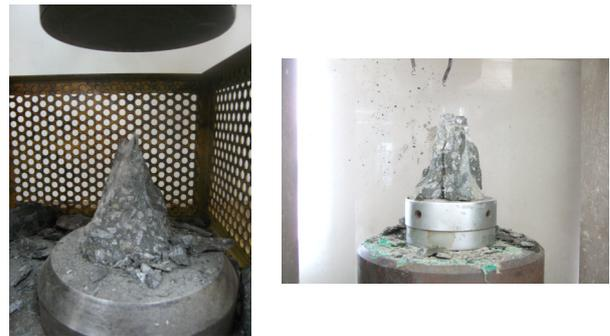
사진 1. 압축강도 시험 후 공시체 파괴상태
