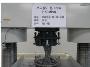
사진 2 압축강도 시험
